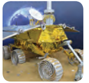
Çin'in keşif aracı Yutu (Yeşim Tavşan) Aralık ayında Ay yüzeyine iniş yaptı. Araç 1,5 metre yükseklikte, stereo kameraya, yeraltı radarına ve tayfölçerlere sahip.
