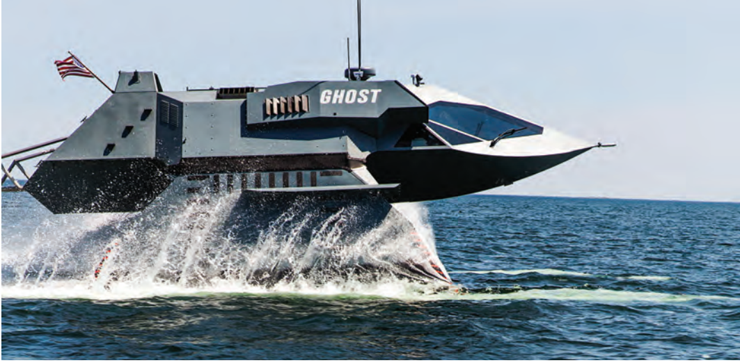
Ghost, suyun 1,8 m altındaki, ucunda pervane bulunan batmaz şamandıralar üstünde hareket ediyor.
