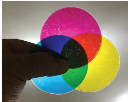
▲ Şekil 1b: Ana renk filtreleri yardımıyla ara renkleri ve en koyu renk elde edilmesi
