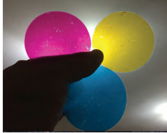
▲ Şekil 1a: Magenta, Cyan ve Sarı baskı boyalarıyla elde edilen ana renk filtreleri
