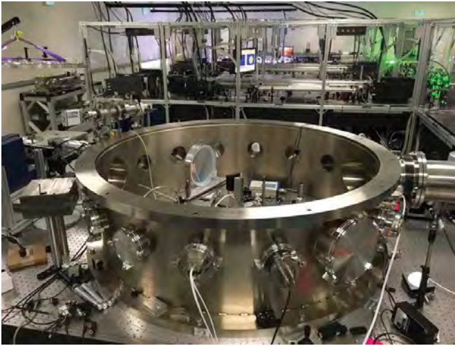
Colorado Eyalet Üniversitesindeki mikro ölçekli füzyon deneyinde kullanılan hedef odası (önde) ve ultra yüksek yoğunluklu lazer (arkada)
