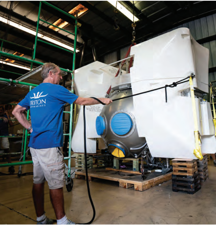
Yapım aşamasında Limiting Factor yarı-bitmiş halde. Batiskaf aslında çevresi köpükle desteklenmiş bir titanyum küreden ibaret.
