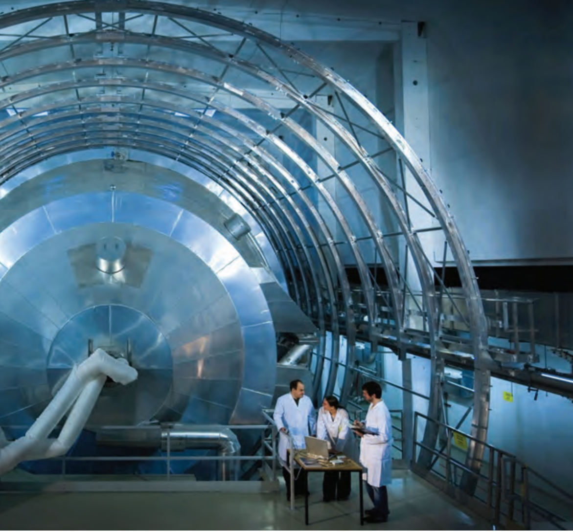
KATRIN deneyindeki ana spektrometre. KATRIN'in amacı evreni kesin olarak anlamak için nötrinin kütlesini ölçmek.
